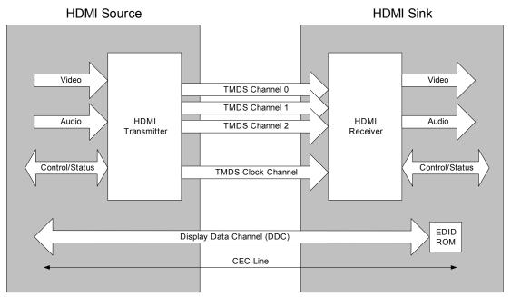
Figure 3-1 HDMI Block Diagram
